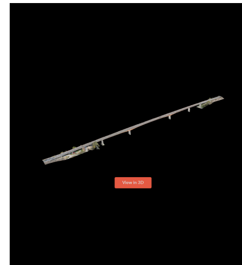
Модел мост Батина–Бездан приказује мост Батина снимљен геореференцираним 3Д скенирањем и фотограмetriјом. Обухвата горњи и доњи део конструкције, површинске текстуре за визуелни преглед и детаљну геометрију за мерења и анализу, те омогућава поређење са класичним прегледима и идентификацију већих оштећења. Извор: Аутор текста
