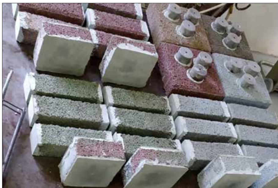
Мултифункционални прототип порозне плоче од лакоагрегатног бетона
