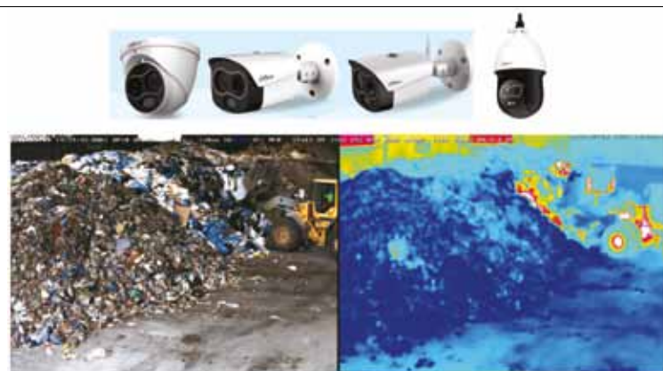
Детекција врелих површина термалном камером
