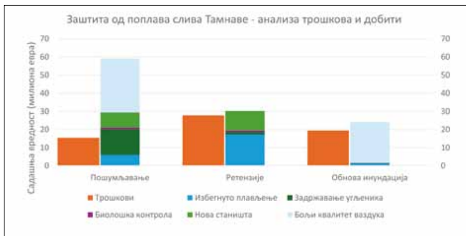
Предлог хибридног решења за слив Тамнаве: економска вредност свих користи, укључујући избегнуте штете од поплава и друге користи, потврђују исплативост решења 3
