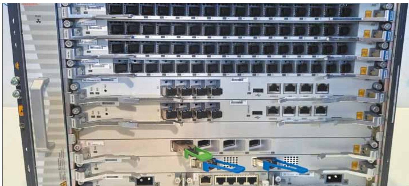
Пример ZTE OLT ZX10 C650 са 50G PON линијском картом GFEC
