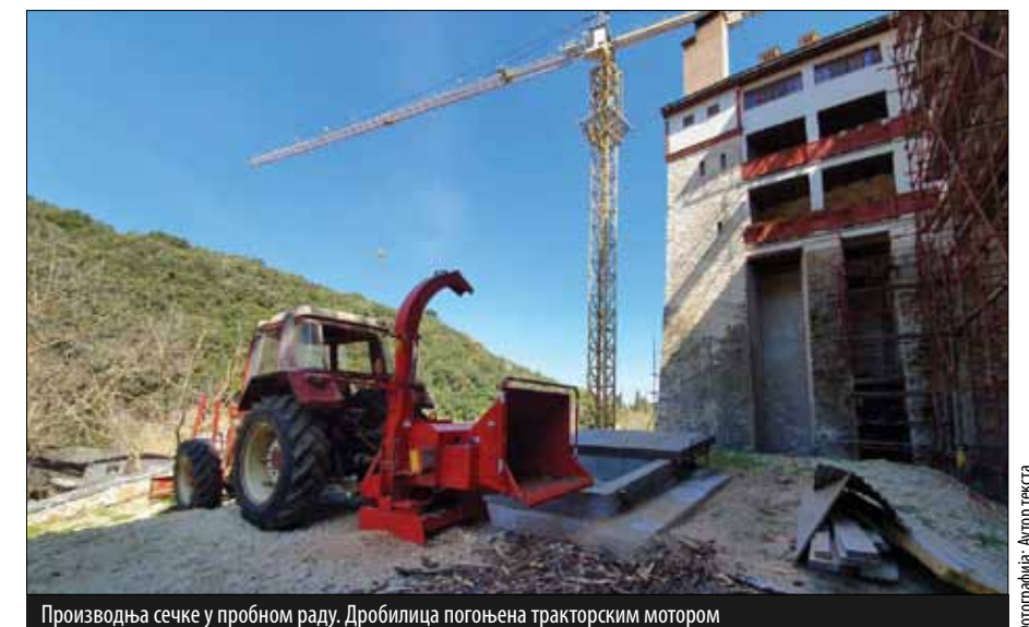
Производња сечке у пробном раду. Дробилица погоњена тракторским мотором
