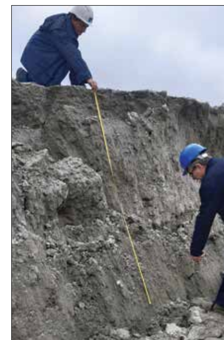
Пукотина затезања, h_s=2.20 m, на I БТО систему, унутрашње одлагалиште површинског копа „Дрмно“, 1.6.2020. (y-7 520 061.12; x-4 954 946.67)
