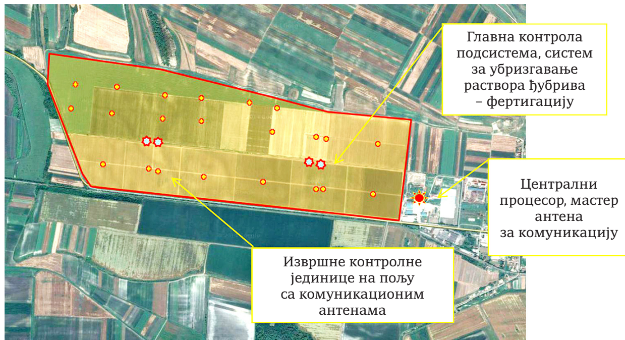
► Слика 3 – просторни распоред опреме за управљање и комуникацију система за наводњавање
