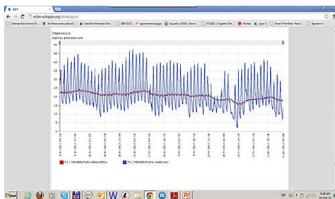
Слика 8 – Праћење температуре земљишта (црвена линија) и температуре ваздуха (плава линија)
