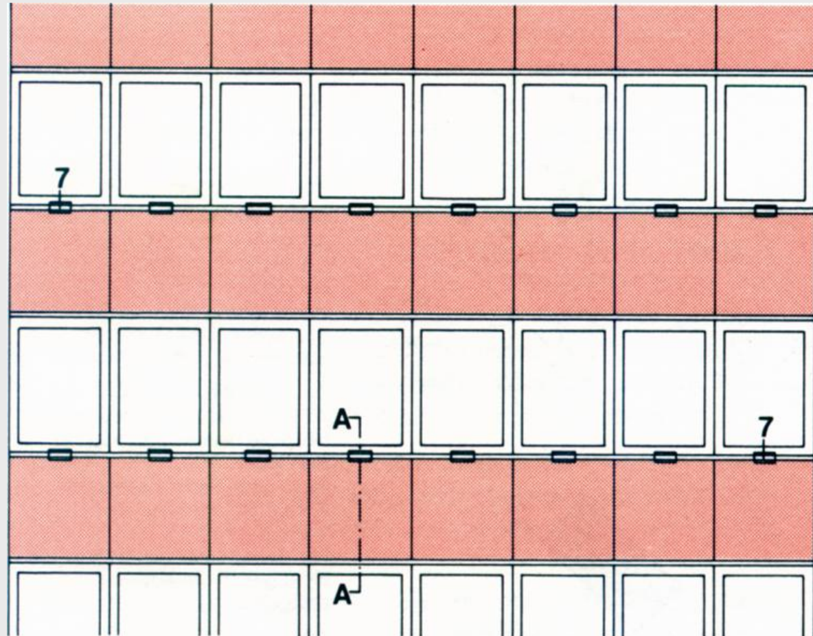
Лужна фасада са прозорима у низу ваздушни колектор у парпету
